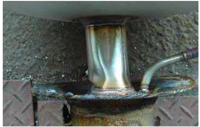
ネックチューブに発生した座屈 （発災容器とは別の容器）
