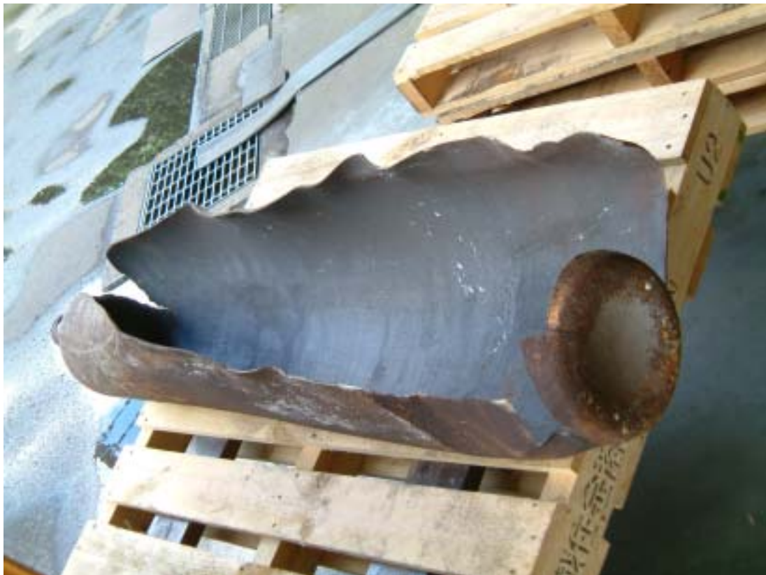
破裂容器の全景
