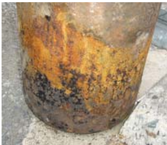
破裂しなかった容器の腐食状況
