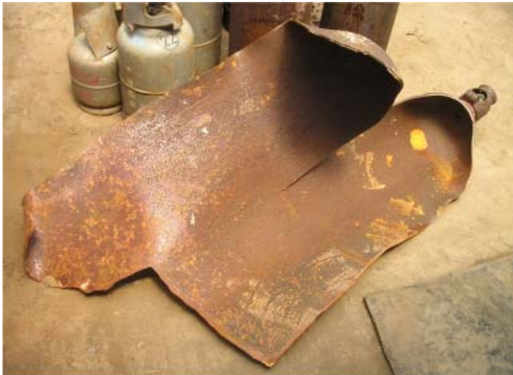
破裂容器の状況(最小肉厚 2.4mm)
