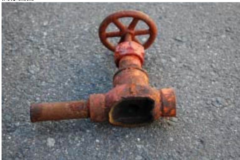
写真 1 破損した吐出弁
