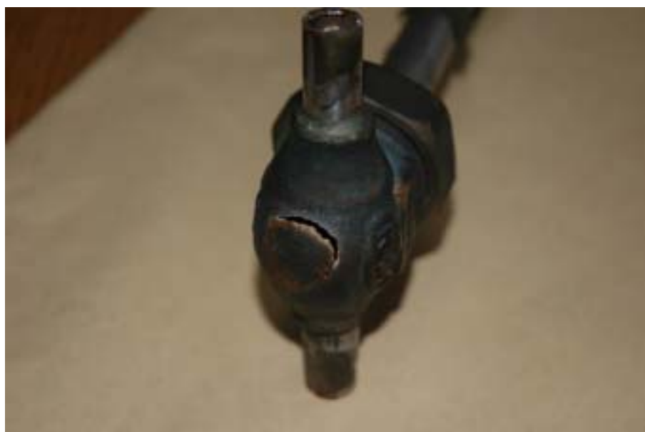
写真 4 プロ-弁の破損状況 その2
