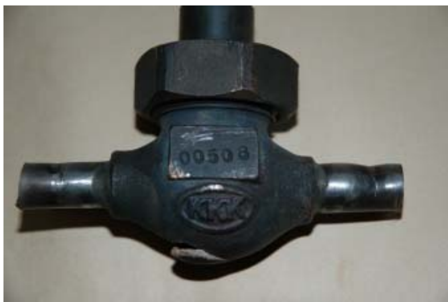
写真 3 プロ-弁の破損状況 その1
