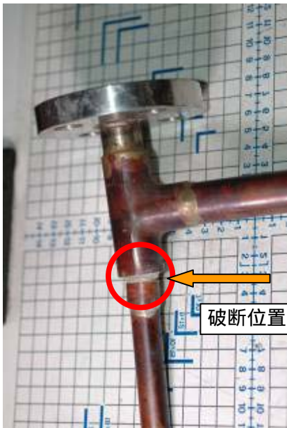
破断した部分
