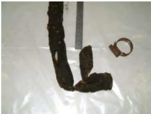
写真1 焼損した塩ビホース
