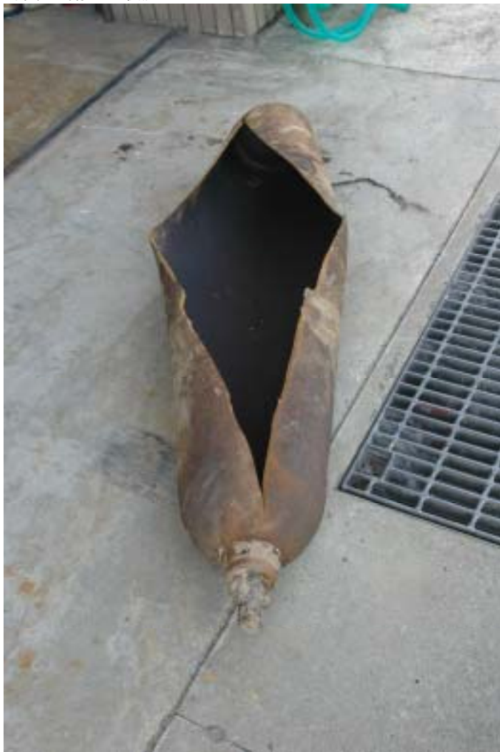
写真 6 容器の破裂状況
