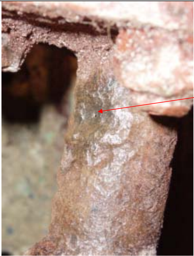
写真 2 外面腐食の状況 (矢印は孔食箇所)
