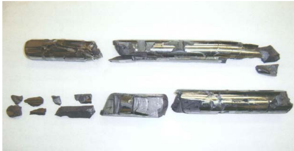
写真 破損したプランジャー
