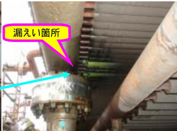
写真 2 漏えい箇所付近 (発災直後に下側から撮影)
