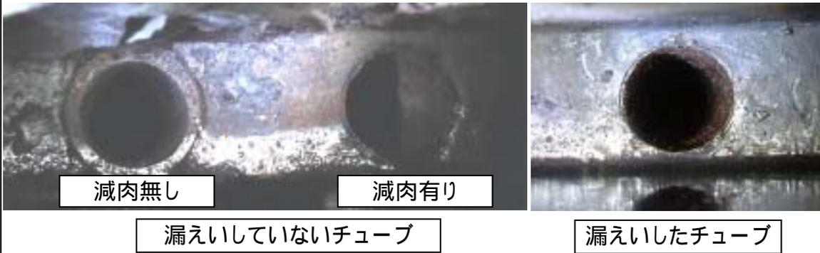
写真3 配管内部の減肉状況(ヘッダー内側から撮影)
