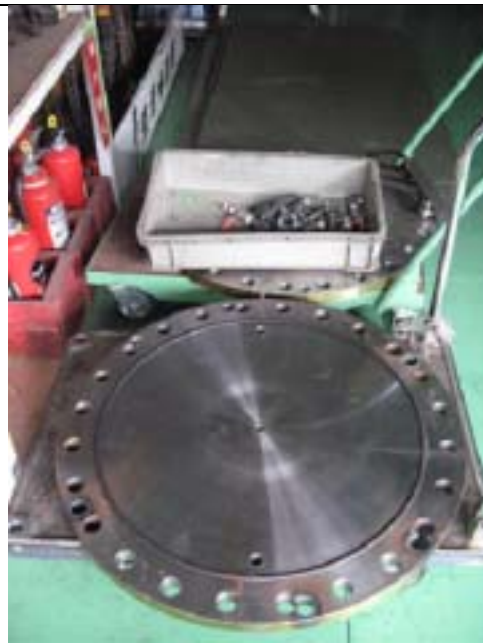
写真2 吹き飛んだフタ板(裏側)
