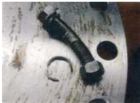
写真3 ボルト・ナットと破断した平座金
