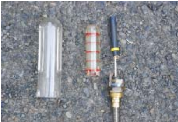
写真 液面計の損傷
