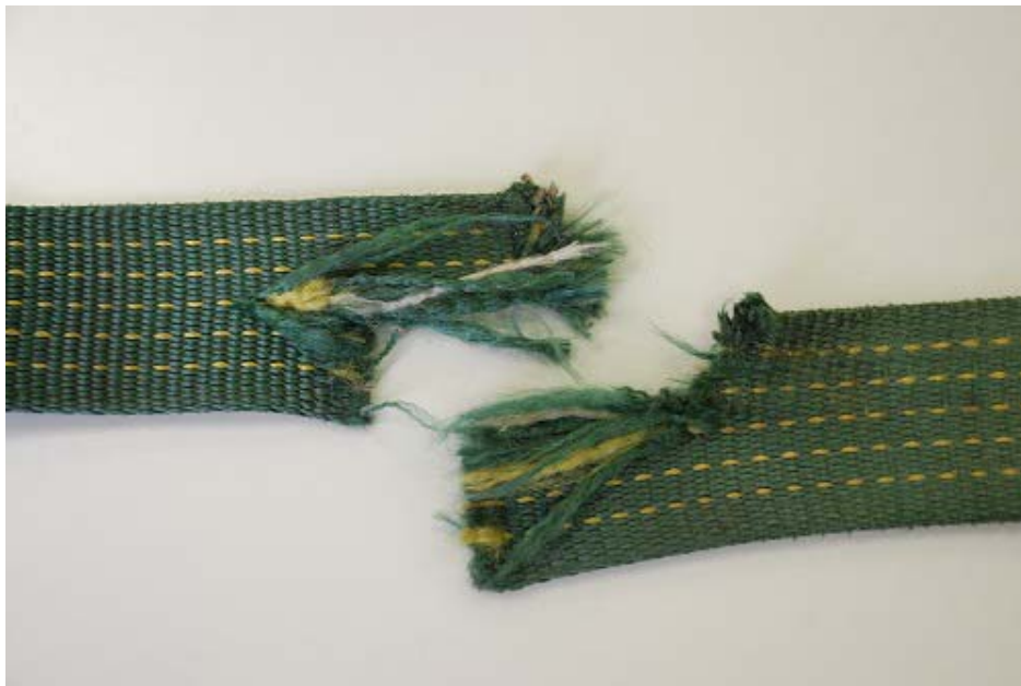
写真 切断した荷締め機のベルト
