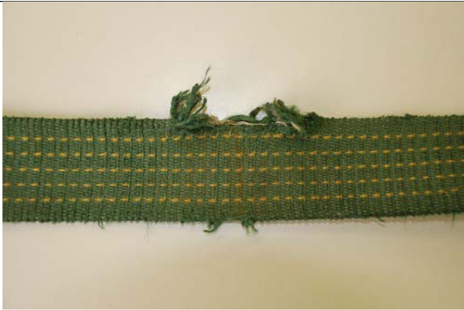
写真 ベルトの損傷
