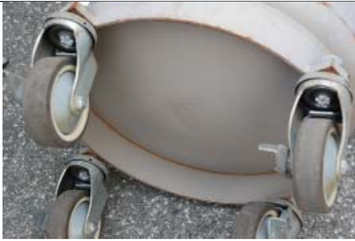
写真 下部鏡の損傷状況
