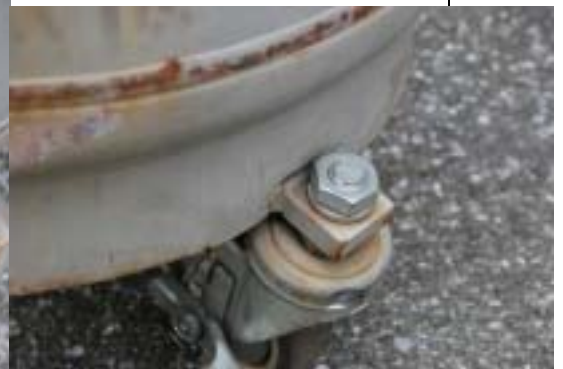
写真 キャスターの損傷状況
