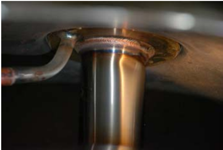
写真 内槽のネックチューブの損傷状況
