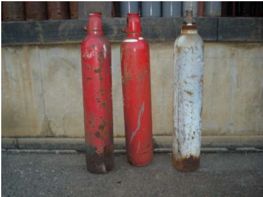
写真5 左:飛翔した水素容器、中央、右:水素容器と窒素容器(いずれも底部腐食が著しい)
