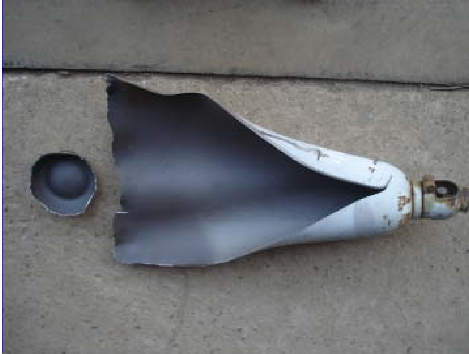
写真 1 破裂した窒素容器
