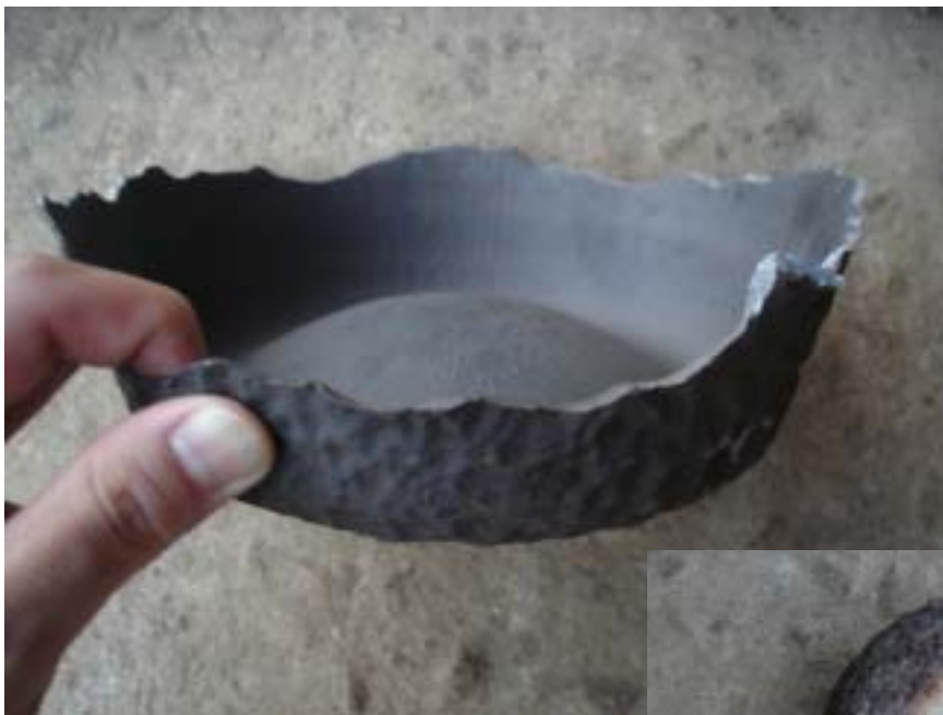
写真 2 底部の腐食状況
