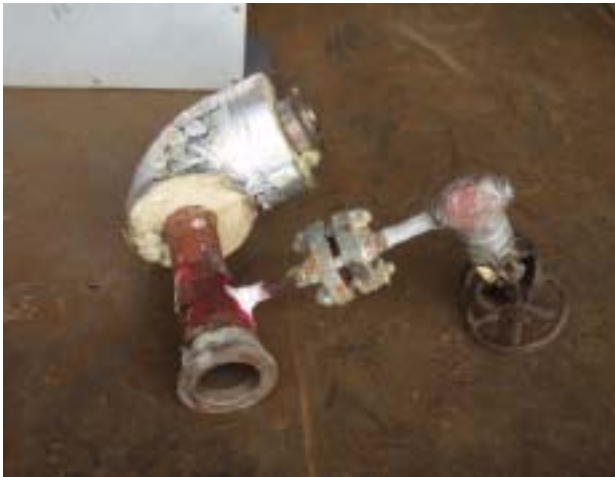
写真3 部のPT検査写真
