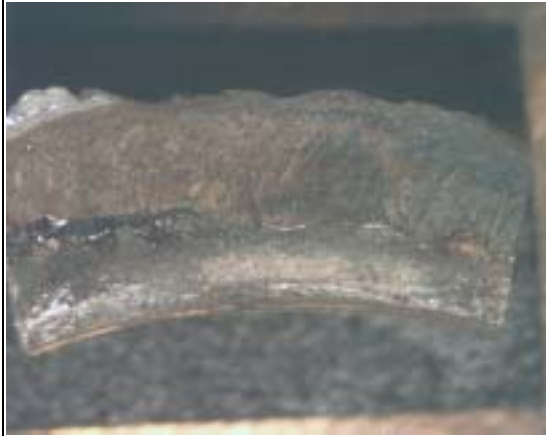
写真7 漏えい箇所 B 破面観察結果 写真8 漏えい箇所 B 光学顕微鏡による断面写真 (腐食液:5%ナイトル液、撮影倍率 3.2 倍)
