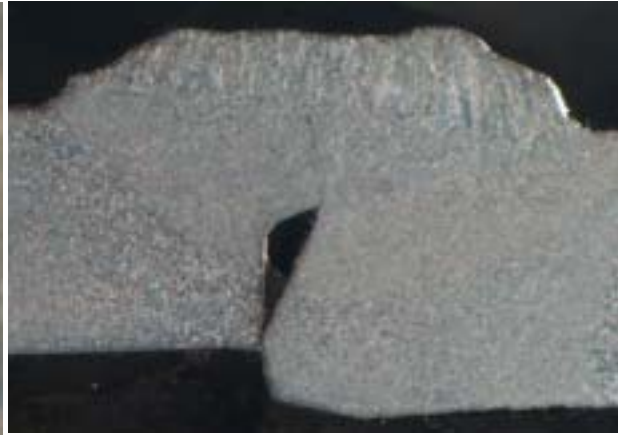
写真7 漏えい箇所 B 破面観察結果 写真8 漏えい箇所 B 光学顕微鏡による断面写真 (腐食液:5%ナイトル液、撮影倍率 3.2 倍)
