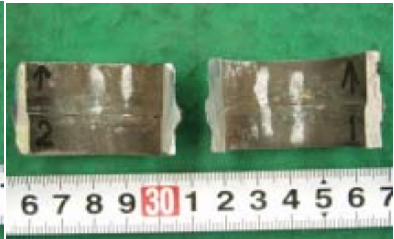
写真 4 漏えい箇所 B 外面及び内面写真
