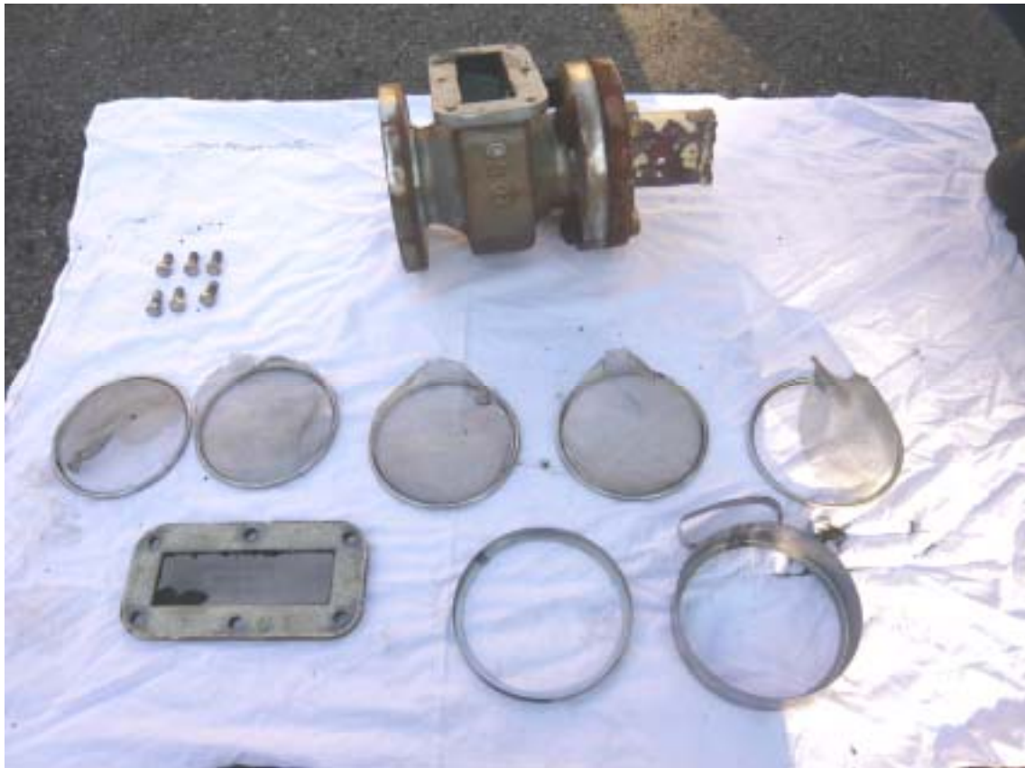
写真6 フレームサレスタ及び内部の金網
