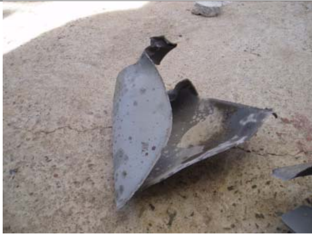
写真3 破裂容器の状況(その2)
