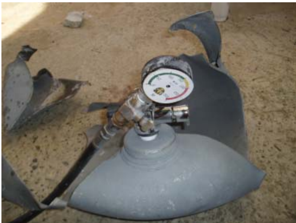
写真2 破裂容器の状況(その1)
