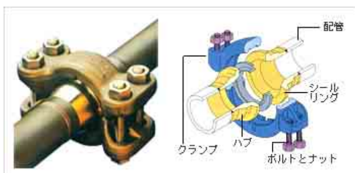
図3 グレイロック継手の構造概要(メーカーのホームページより抜粋。)
