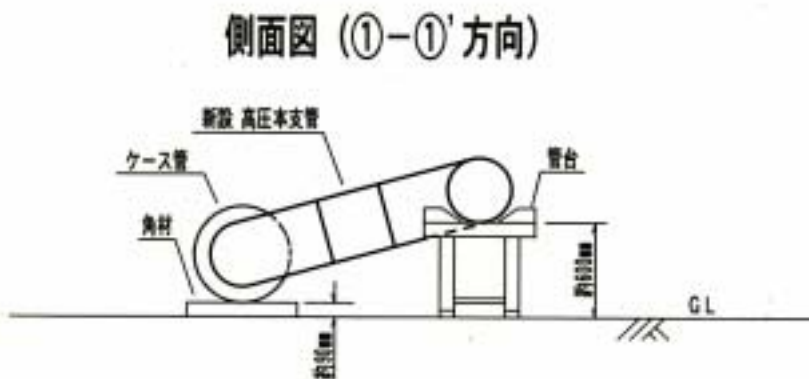
図5 耐圧試験時の高圧導管の配置状況(その2)
