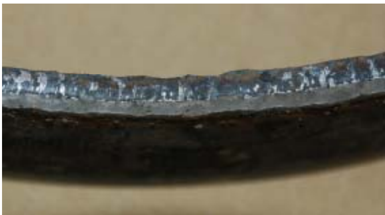
写真6 導管端面(下側 1/3 が溶接部)の破断状況
