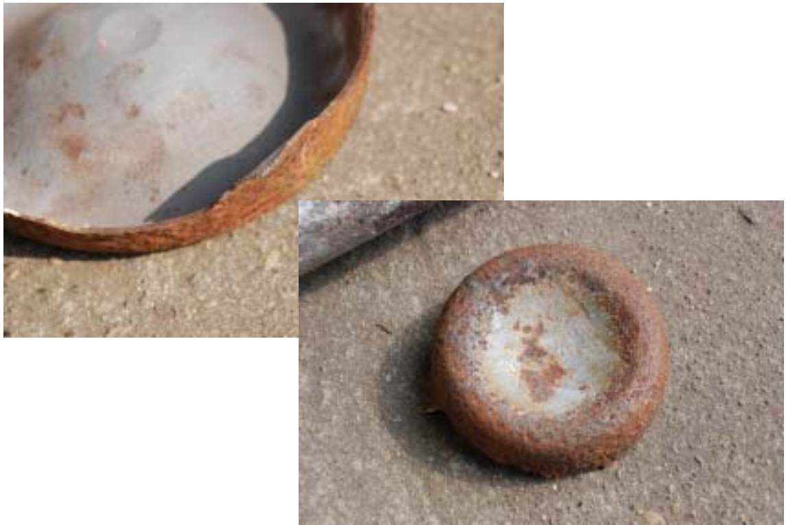
写真5 底部の腐食状況
