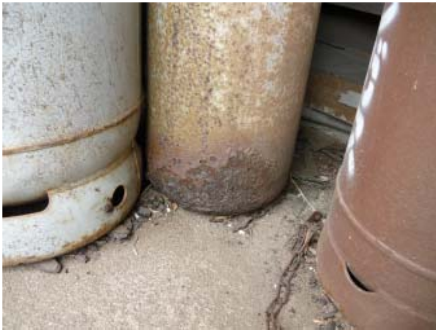
写真6 同じ容器置場にあった窒素容器の腐食状況
