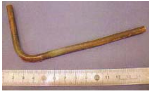
写真5 均圧配管外観
