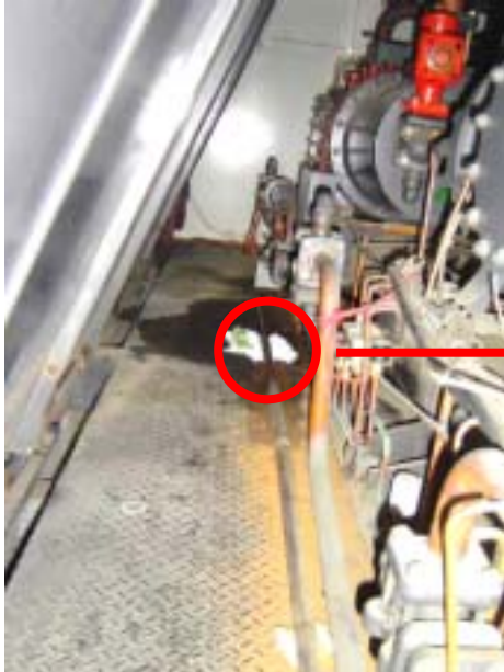
写真 8 漏えい箇所付近外観
