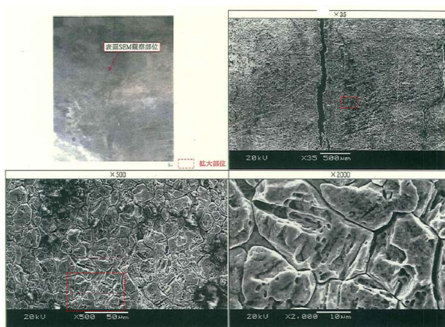
写真 6 破面の SEM 観察結果
