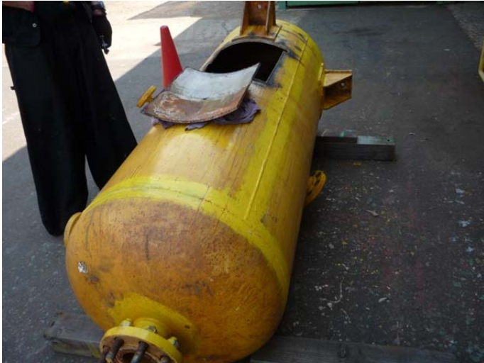
写真2 クッションタンクの開口部の切断状況(その2)
