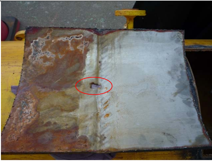
写真3 開口部の状況(→上側)
