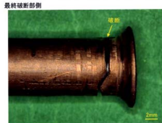
写真7 鋼管の破断箇所
