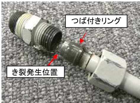
写真3 鋼管(くい込み継手)の外観
