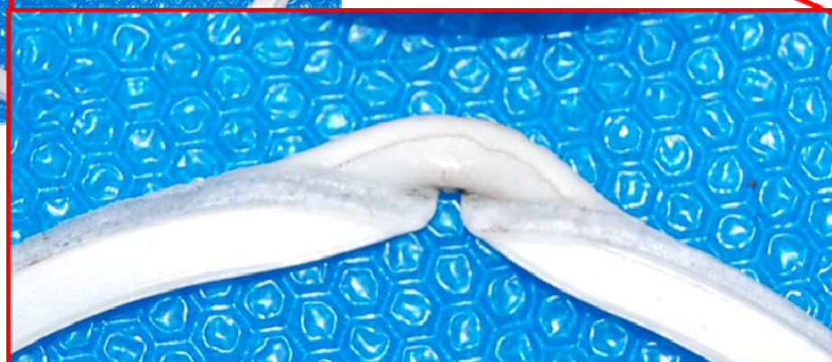
写真2 ガスケットの変形状況
