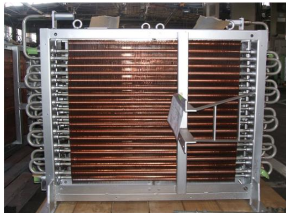
写真5 クーラー全体(改造後)
