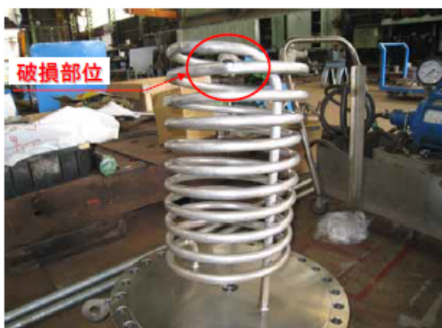
写真2 内部加熱コイルの損傷状況
