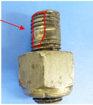
写真3 クロスヘッドシュー取付けボルト
