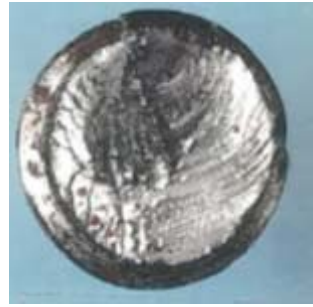
写真4 クロスヘッドシュー取付けボルト破面
