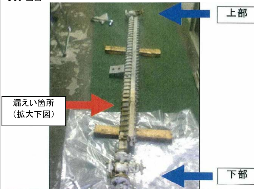
写真1 液面計全景(下部より一段目サイトグラス上部から漏えい(全5段))
