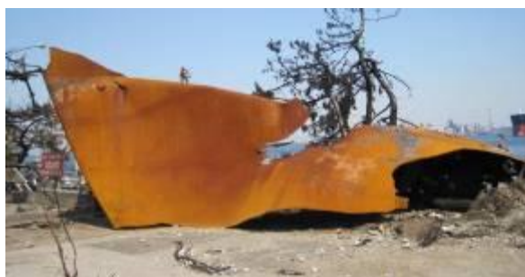
写真4 貯槽破裂後に飛散した破片
