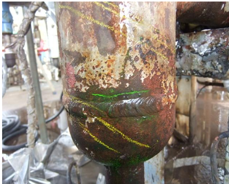
写真 2 連通管下部に発生した溶接線近傍の割れの状況
