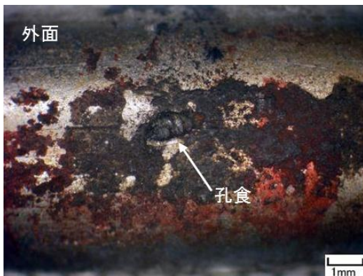
写真 5 漏洩部の詳細(左:外面、右:内面)
