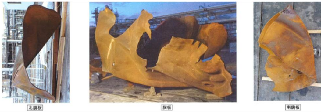
写真3 塩酸塔還流槽の破壊状況
