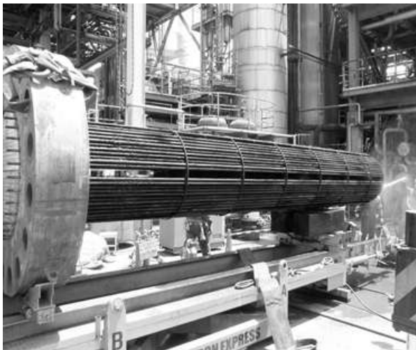
写真 1 事故後のチューブバンドルの状況
