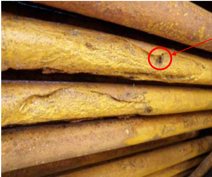
写真3 腐食開口部と減肉状況(#24-6 開口、#24-5 減肉)
