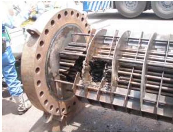
図 2 熱交換器チューブの溶損
