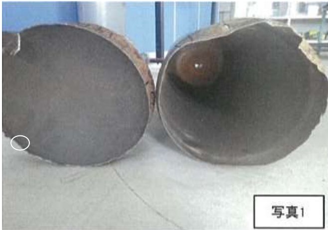
写真1 左:下部鏡板内面、右:胴部内面の状況
