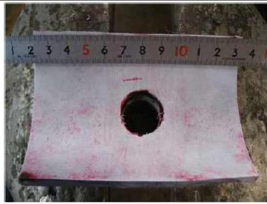
写真 4 割れの状況(内面)
