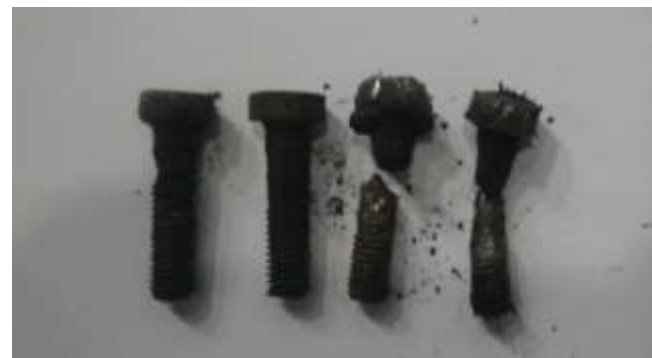
図5 ストレーナーボルトの腐食および破断状況
