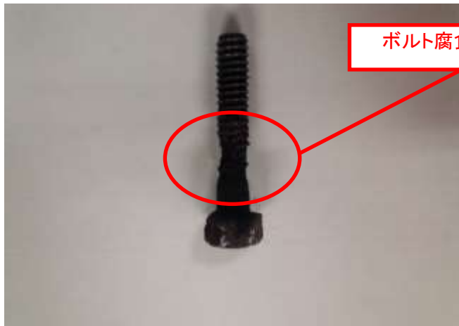
図4 ストレーナーカバーの腐食破断したボルト
