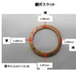
銅ガスケットの寸法測定記録 (写真はアルミガスケットとの接触側)
