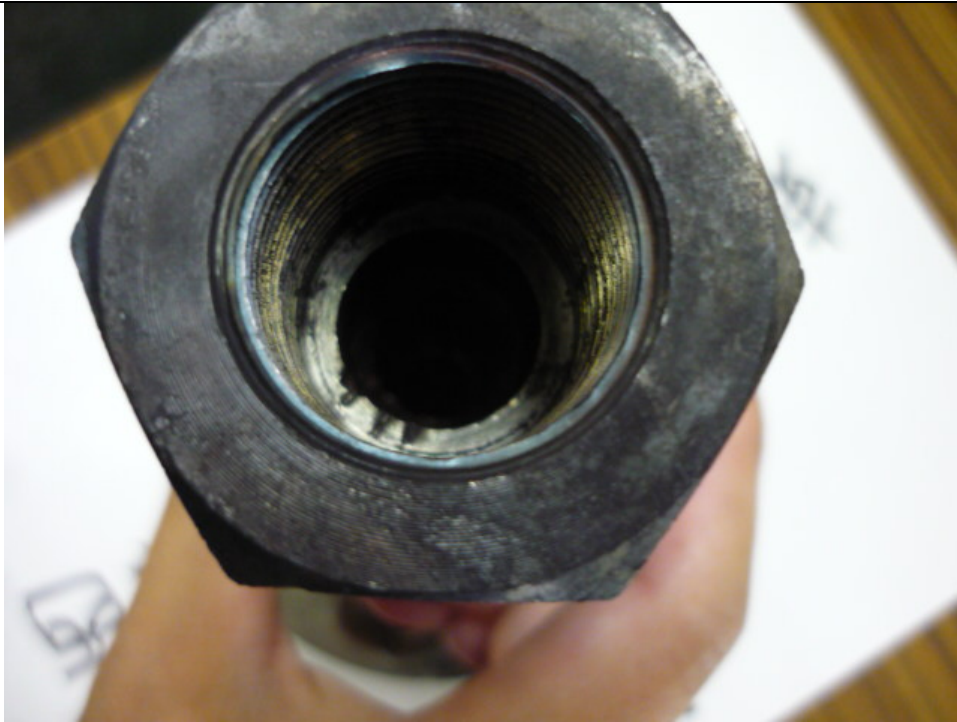
図4 圧力計受け座の打痕
