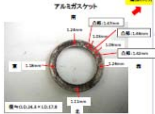
アルミガスケットと受け面の接触側の写真 (写真外側寸法測定値はガスケット取り外し時に、圧力計受け面の加工面(内径24.78mm)に引っ掛かって、変形した後の値。)
