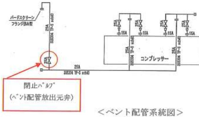
図2 ベント配管系統図
