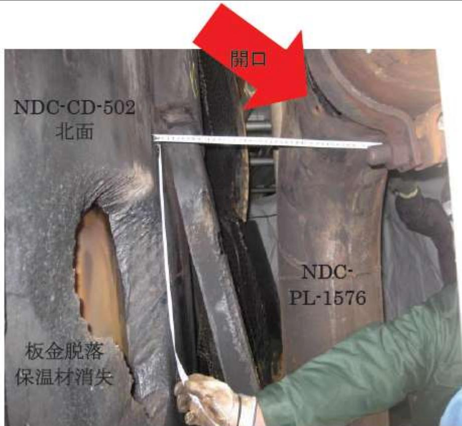
図8 配管開口部と保温材焼損部の位置関係
