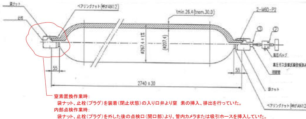
図2 開放検査時の蓄圧器の概要
