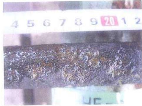
図8 伝熱管:残肉厚 0.2mm
