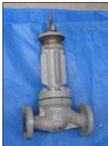
写真 5 アンモニアが漏えいし、死傷事故を起こした膨張弁
