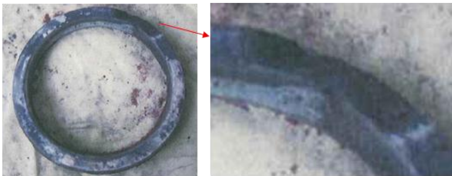
写真3 ガスケット劣化・腐食による事例
