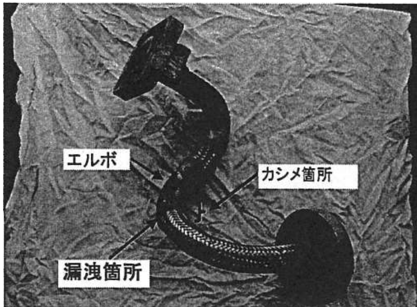
写真2 ディスペンサー内部の可とう管(事例②)
