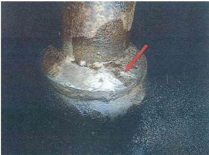
写真3 隅肉溶接部のピンホール（矢印）
