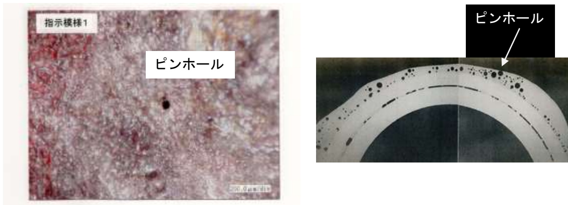
写真 ろう付不良に起因したピンホール
