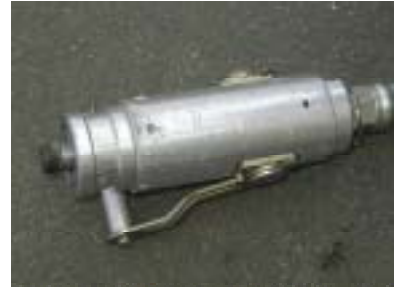
交換したカップリング (事故時のものと同型)
