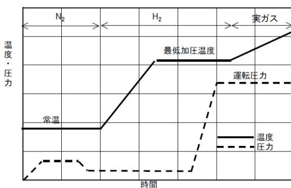
図 脱硫装置でのホットスタート時の昇温加压の例
