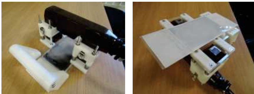
図 B.3—組立後の密閉型磁粉探傷装置（製品例）
