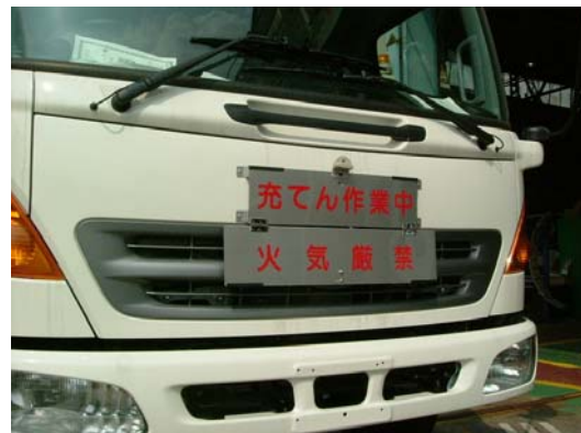
「充てん作業中」等の標識例
