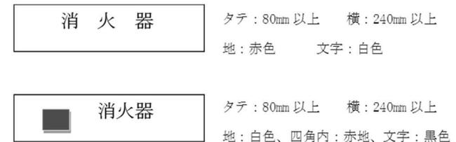
図 13 消火設備を示す標識の例
